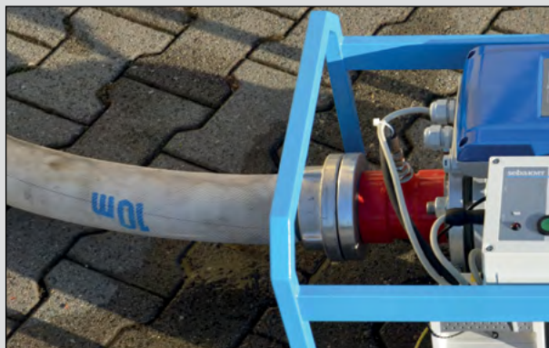
Подсоединение пожарных рукавов тип В.
