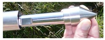
Schritt1: Montage der Spitze am Rammgestänge und Einführen des Rammgestänges im Hüllrohr
