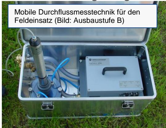
Wir bieten Ihnen die Durchflussmesstechnik in 3 Ausbaustufen an:
